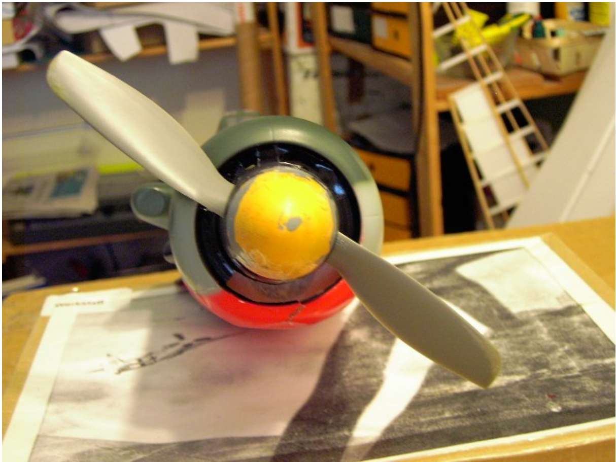
Ein aus einem 10 x 10 APC-E gefertigter 8 x 10 Propeller.
