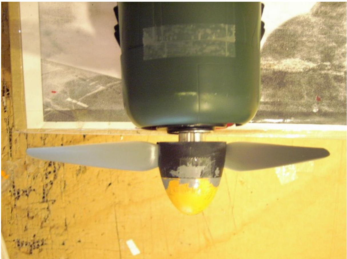
Ein aus einem 10 x 10 APC-E gefertigter 8 x 10 Propeller.
